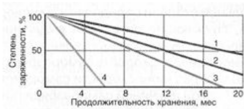
Рис.4 Изменение уровня заряженности автомобильных аккумуляторов различных конструкций при хранении:
