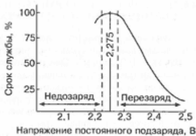
Рис.8. Воздействие режима заряда на срок службы герметизированной свинцово-кислотной аккумуляторной батареи при работе в буферном режиме
